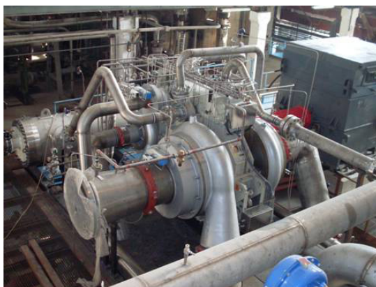
Převodový kompresor 8 RKB 62 na stlačování \text{CO}_2 pro jednotku výroby močoviny
