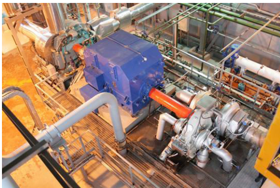
Kompresor 4 RKB 44 poháněný elektromotorem a expanzní turbinou pro využití energie odpadních plynů pro jednotku oksylení cyklohexanolu
