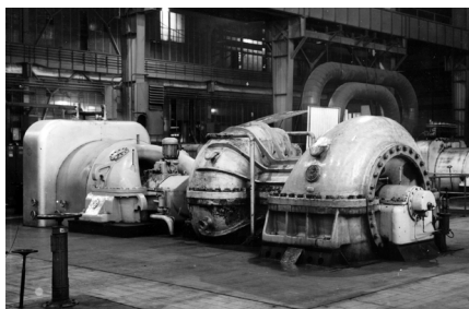
Osové vysokopecní dmychadlo s axiálním kompresorem pro kombinát Kunčice
