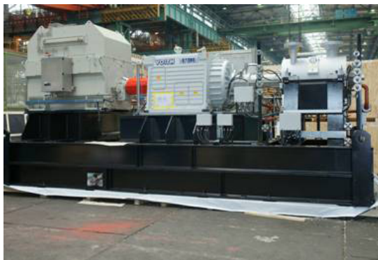
Odstředivý barelový kompresor 7 RSA 39 na vodíkový plyn s tlakem na výtlaku 9,6 MPa s regulací otáček pomocí hydrodynamické spojky
