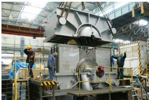
Vzduchový kompresor 5 RMX 99 o výkonu 90\,000\text{ m}^3\text{h}^{-1} a výtláčným tlakem 7,4\text{ MPa} pro dodávku vzduchu pro jednotku dělení vzduchu
