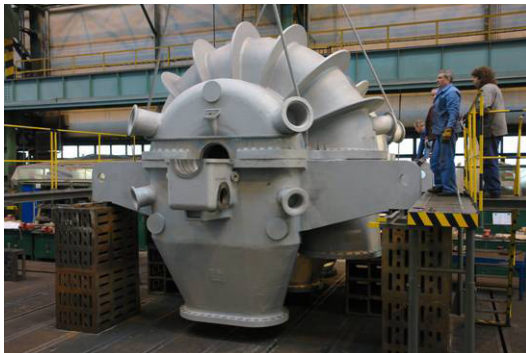
Vzduchový kompresor 7 RMA 122 o výkonu 330 000 m 3 h -1 s tlakem na výtlaku 0,52 MPa pro dodávku vzduchu do vysokých pecí
