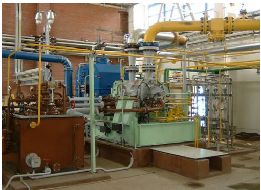
Barelový kompresor 4 RSA 32 pro jednotku izomerizace stlačující směs uhlovodíků bohatou na vodík v rafinerii nafty
