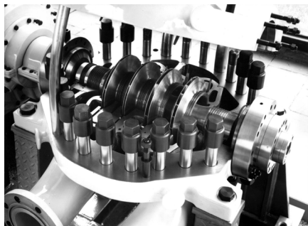
Čpavkový chladivový kompresor s oběžnými koly z titanové slitiny v jednotělesovém provedení
