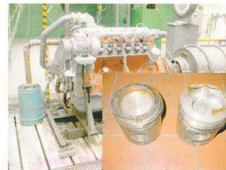
Plynový motor kogenerační jednotky TEDOM CENTO 100 na zkušebně s testovanými spalovacími prostory
