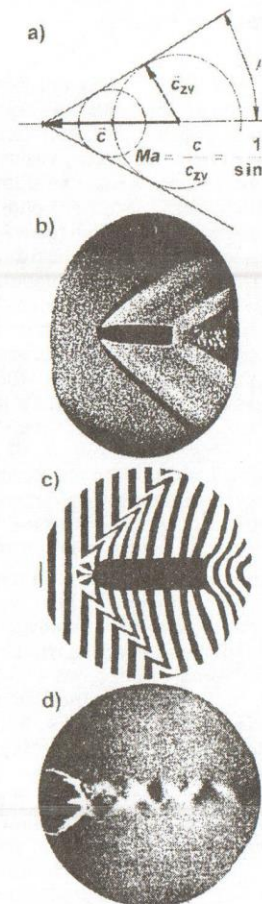
Obr. 10. Některé Machovy objevy: a) Machův kužel (1886), b) šířivá fotografie kuželové rázové vlny na přídi střely letící nadzvukovou rychlostí (2. polovina 80. let), c) interferometrická vizualizace (spolu se synem Ludwigem, kolem r. 1900), d) šířivá vizualizace podexpandovaného výtoku z trysky (spolu s prof. Salcherem, 1888).
