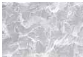
Příklad lomové plochy - štěpné porušení
