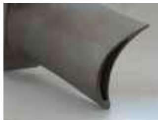
Příklad odlitku vyrobeného technologií přesného lití na vytavitelný model (lopatka plynové turbíny vyrobená z niklové superslitiny)
