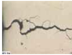
Interkrystalické trhliny v niklu (zařízení na výrobu louhu)
